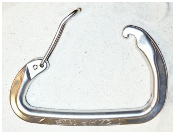
Obr. 1.11: Prasknutá karabína z nehody na Bořni.
