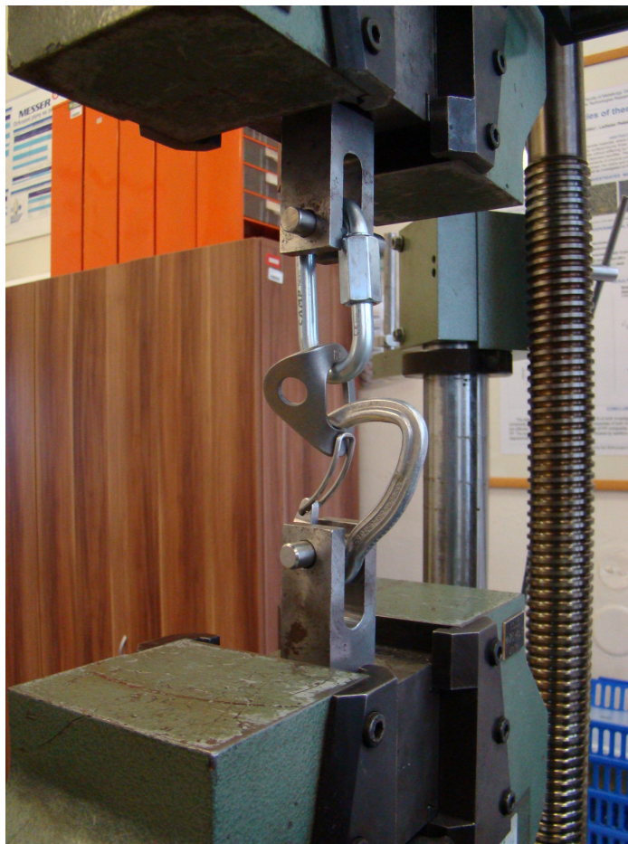
Obr. 3.6: Uchytenie karabíny v skúšobnom stroji na KNoM HF TUKE.
