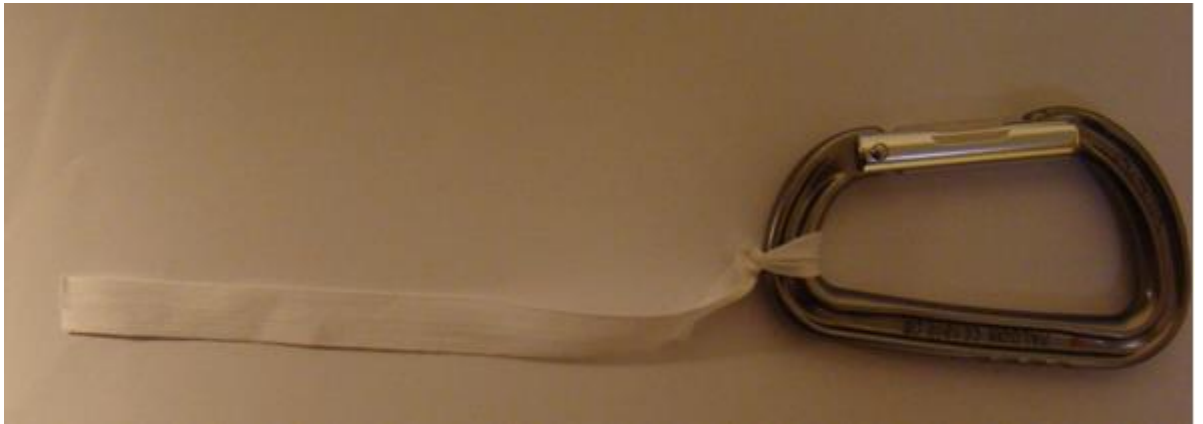
Obr.2 Karabína so stužkou pripravená na testovanie
