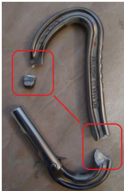
Obr. 6 Karabína po trhacej skúške. Pri odlomení nosu následný lom v stave s otvoreným zámkom v spodnej časti.
