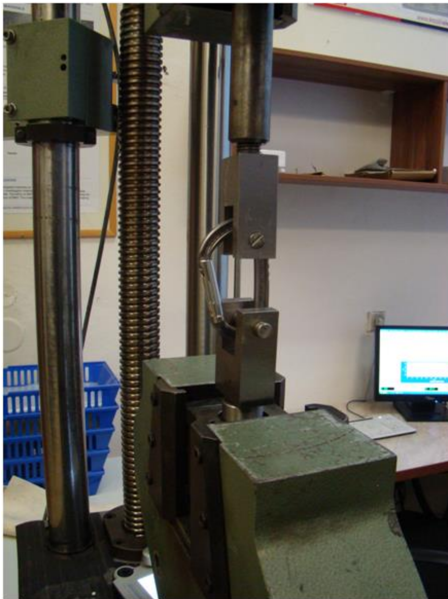
Obr. 5 Karabína pripravená na trhaciu skúšku.
