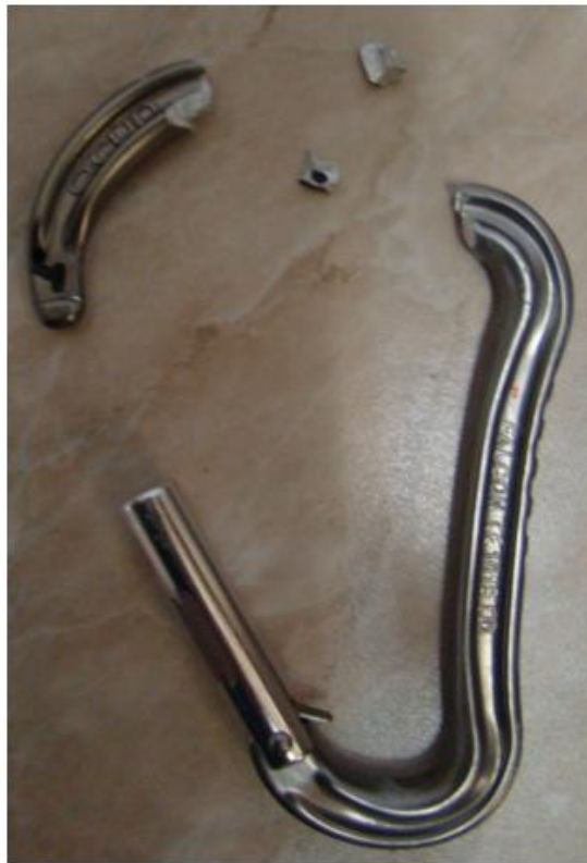
Obr. 7 Po zlomení karabíny za hornú časť tela, opäť nasledoval lom v hornej časti.
