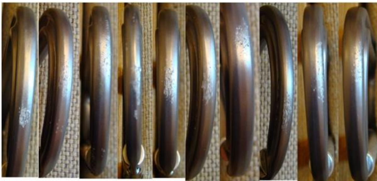
Obr. 4 Poškodenie karabín po páde z výšky 22.5m na betón. Karabíny sú radené z ľava do prava od 1 po 10.
