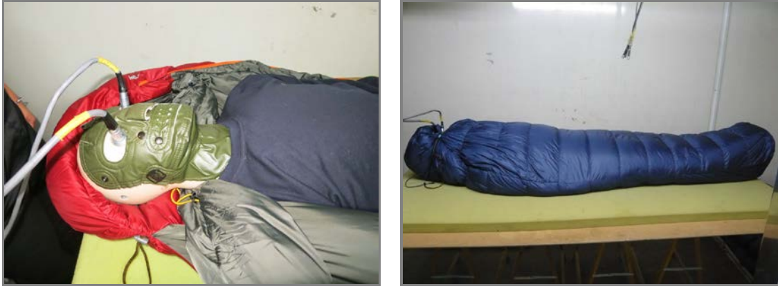
Obrázok 6.1: Testovanie spacieho vaku podľa normy ISO 23537 [3]
